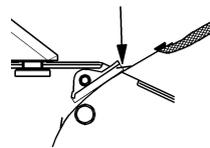
Die Feder der Einzugautomatik an die Metallfalle einhängen.
