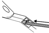
Während die Schnur gehalten wird, das Schnurende langsam unter die Metallführung in den Wickler einziehen lassen.
