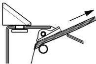
Die Schnur bis zum Anschlag herausziehen und mit leichtem Zug in der Hand festhalten.
